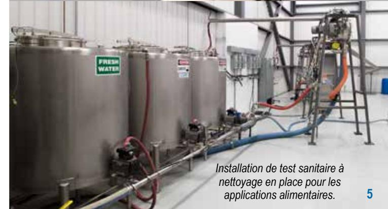
Installation de test sanitaire à nettoyage en place pour les applications alimentaires.
