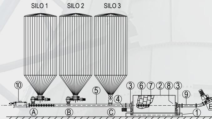
Vidange du silo au travers des tourillons d'alimentation à compression vers le malaxeur rotatif en ligne Luxme
